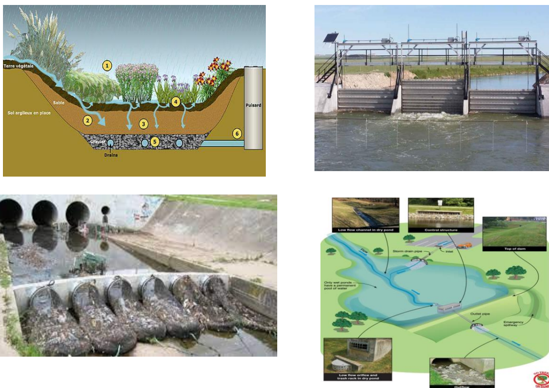
Hình 30: Giải pháp thoát nước bền vững, thoát chậm và trữ nước trong hồ, sông, suối, kênh. Sử dụng các loài thực vật để làm sạch nguồn nước, bố trí thu rác từ cửa xả
